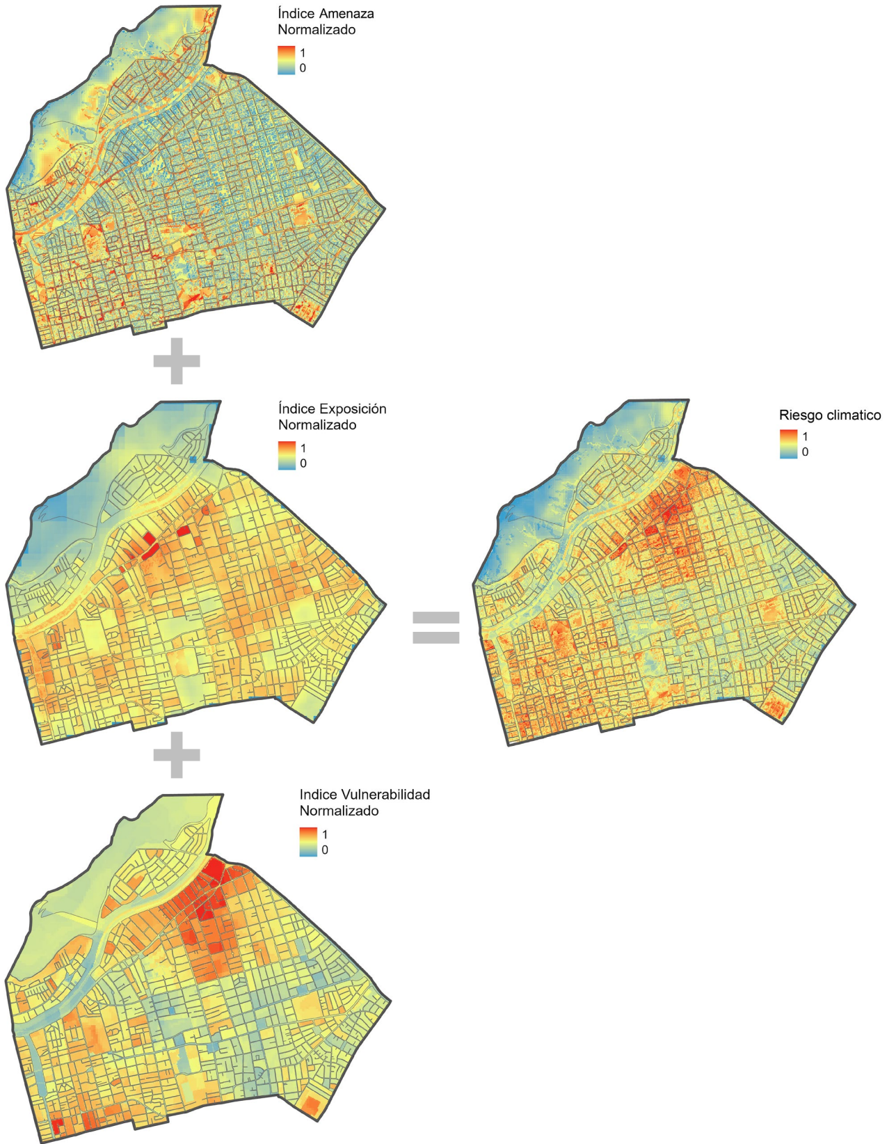
Figura 83. Proceso de construcción del riesgo. Resultado normalizado entre 0 y 1, a mayor valor mayor es el riesgo. Fuente: elaboración propia.
